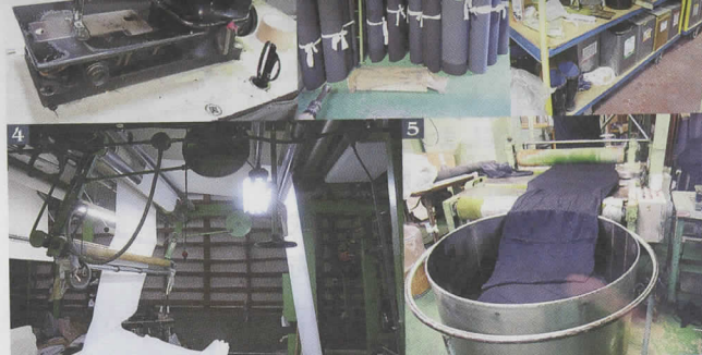
1. 年季の入ったシンガー製のミシン 2. 生地に表情を与える紙やすりのロールは何百種類もある 3. 柔軟や色落ち効果のための薬剤 4. 何本ものロールを通して生地が加工される 5. 柔軟加工を経た生地が大きな器に収まっていく
